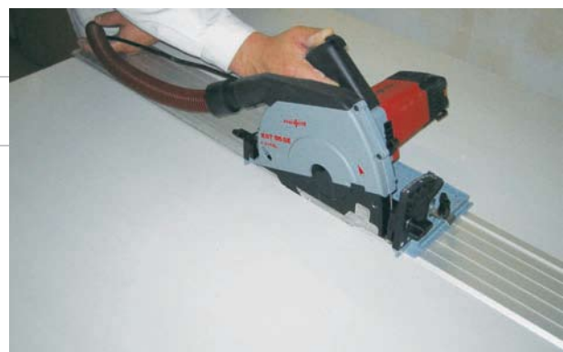
Scie circulaire portable dotée d'une lame en métal dur (lame de carbure)
